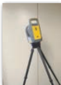
45°まで傾けても計測可能 傾斜が低い場合：青色 傾斜が高い場合：赤色
