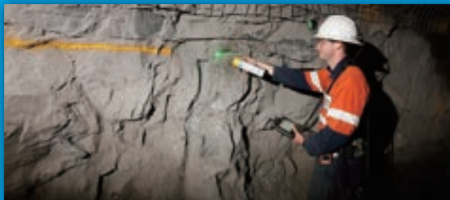
グリーンレーザーで計測ポイントを照射
