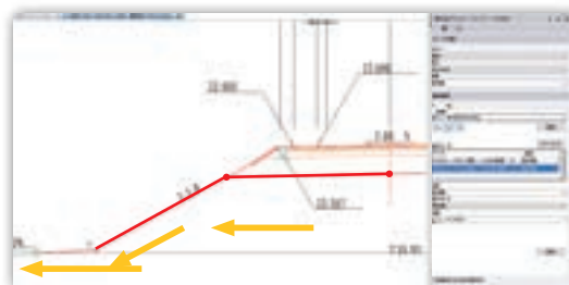
横断面から路体形状をトレース 左右の折れ点を指示するだけで寸法・勾配など様々な情報を取得しコリ ドーを作成するためのテンプレートとなる
