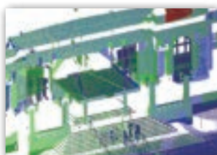
重複するスキャンポイントが多いデータの場合は「ペアの登録」をクリックするだけで高精度の合成が可能
