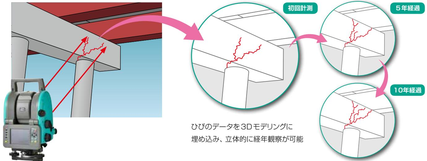
ひびのデータを3Dモデリングに埋め込み、立体的に経年観察が可能
