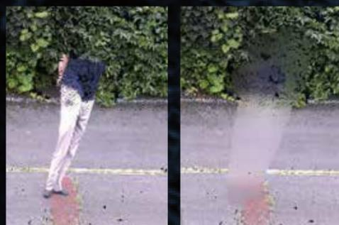
点群に写り込んだ作業者 「軽い」度合いで1回の平滑処理後
