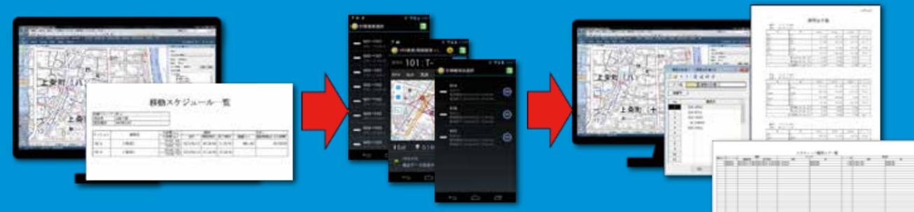
TOWISEで作成した観測計画をそのまま、Trimble SKY Controllerへ渡すことで、特に基準点観測の生産性を高めることのできる観測支援コマンドを追加しました。スタティック観測は受信機またはそれに付随する情報により、移動する順序と時刻が登録されます。VRSを含んだRTK観測では仮セッション名、基線の始・終点が一元管理され、それらの情報をTrimble SKY Controllerへ受け渡し、効率的な観測が実現可能です。
