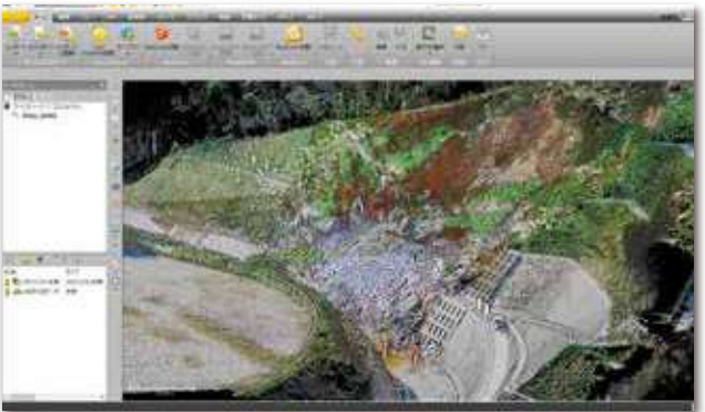
災害による土砂崩落現場データ
