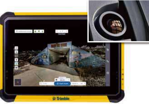
現場で色付けされた 3次元点群
