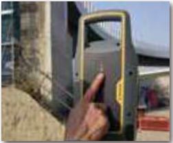
機器横のボタンを押すだけで スキャン開始
