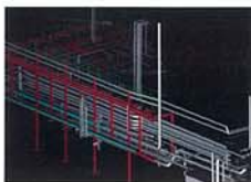
点データを取得し、配管をモデリングする
