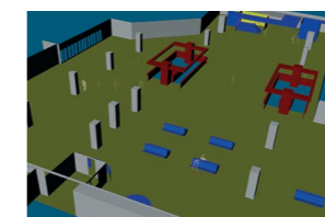
TIMMS - 3D レーザによるフィラデルフィア地下鉄コンコースのモデル
