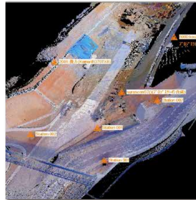
Trimble SX10, Trimble TX8, Trimble S7 SureScanで取得し、合成した複合現場
