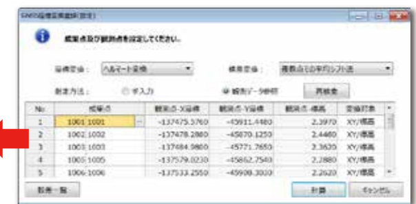
GNSS座標変換設定画面
